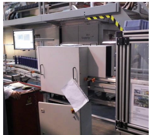
Abbildung 1: Prototyp der Farbprüfanlage PROFAKO an einer Produktionslinie der Firma ALPLA
