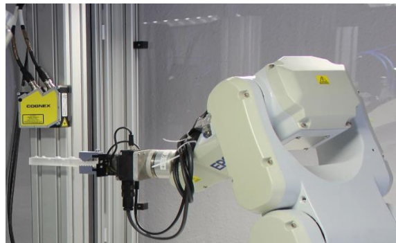
Fliegende optisches Scannen des Werkstückes
