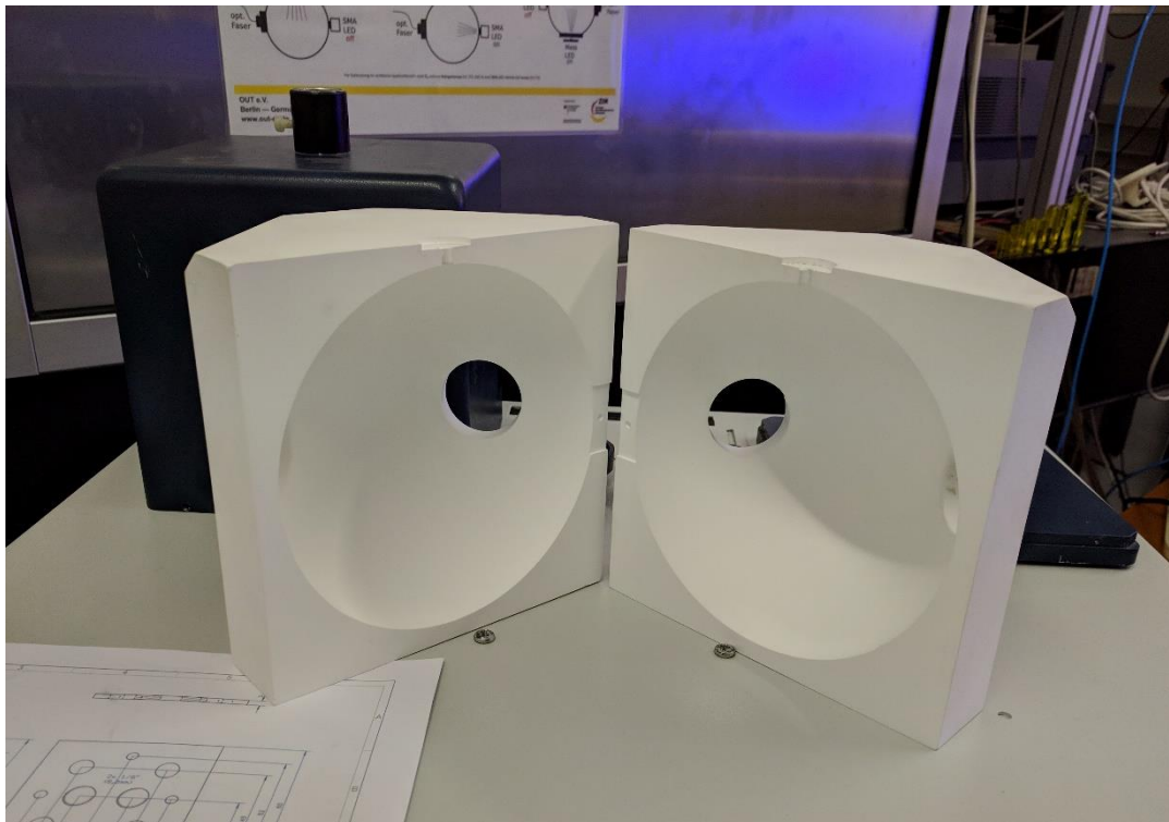
Abbildung 8 Ausgeklappte Doppel-Halbschalen-Ulbrichtkugel als Basis der homogenisierten Testkörpereinstrahlung
