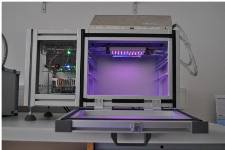
Abbildung 3 Frontansicht des im Betrieb befindlichen Hochleistungs-UV-Ofen zur künstlichen Alterung von Bauteilen durch Beaufschlagung von vorab definierten Strahlungsdosen
