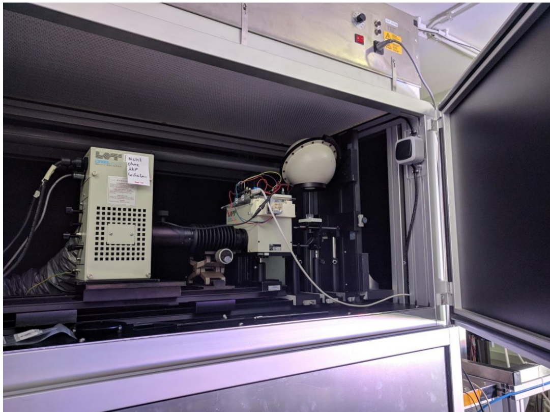
Abbildung 6 Optische Bank im oberen Teil des optischen Tunnels mit verkleideten Seitentüren zur optischen Abschirmung im klimatisierten Optiklabor des Instituts
